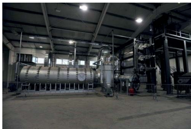
Termokatalitikus hőbontó a shredderezési műanyag és gumimaradékok hasznosítására Fehérvárcsurgón
